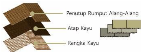
Gambar 21. Aksonometri Atap Bangunan Cottage
