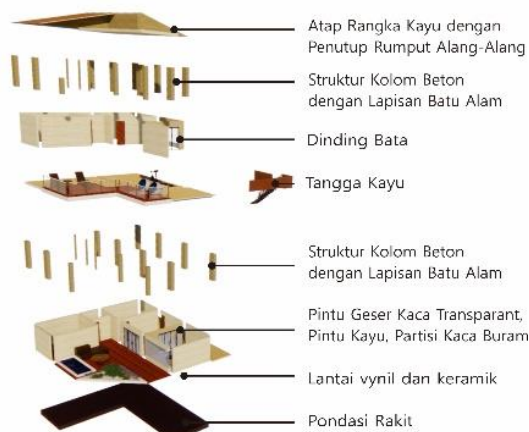
Gambar 20. Aksonometri Struktur Cottage
