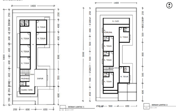
Gambar 2. Denah bangunan indekos (Sumber: Analisis Pribadi, 2025)
