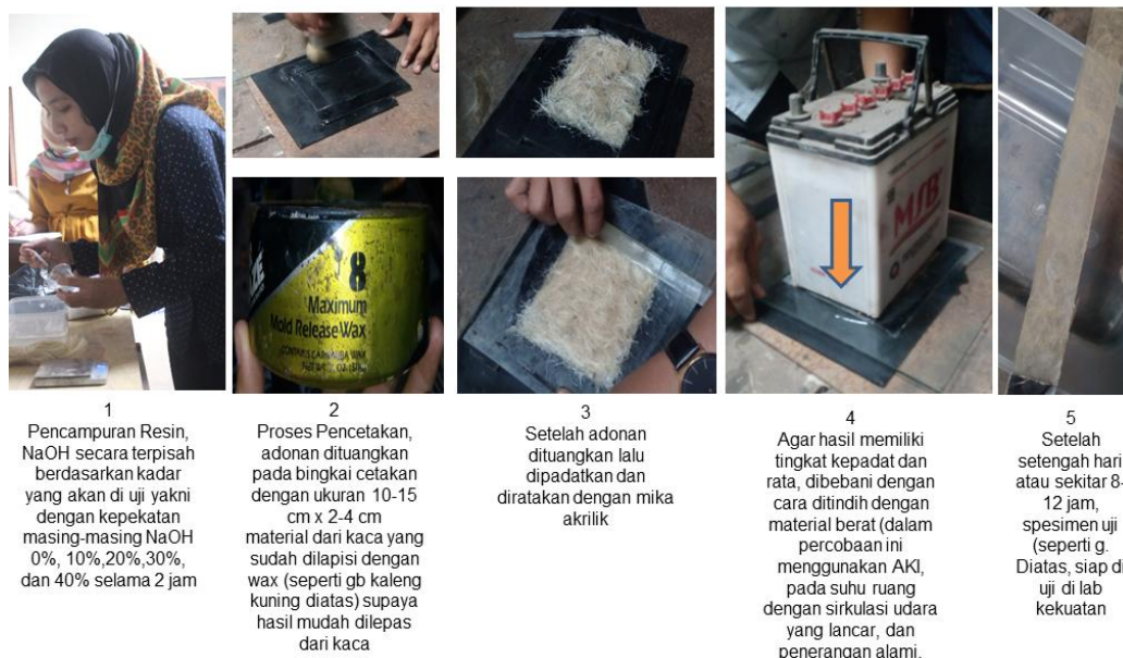
Gambar 6. Proses Pembuatan Spesimen Uji
